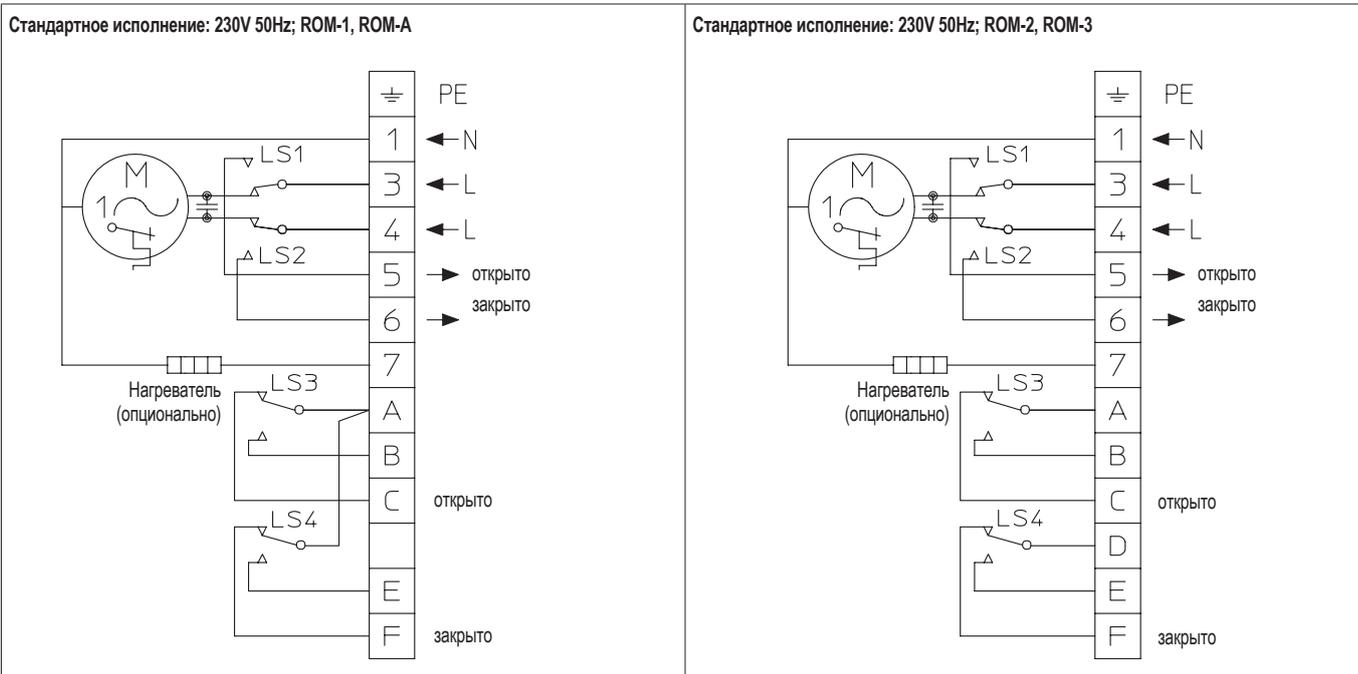
**Поворотный затвор с мягким уплотнением, не требует технического обслуживания с электроприводом Тип: Deufra**
