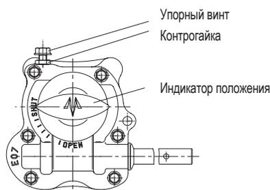
Винт-ограничитель позволяет устанавливать положение «Закрыто» с точностью  $\pm 5$  град.
